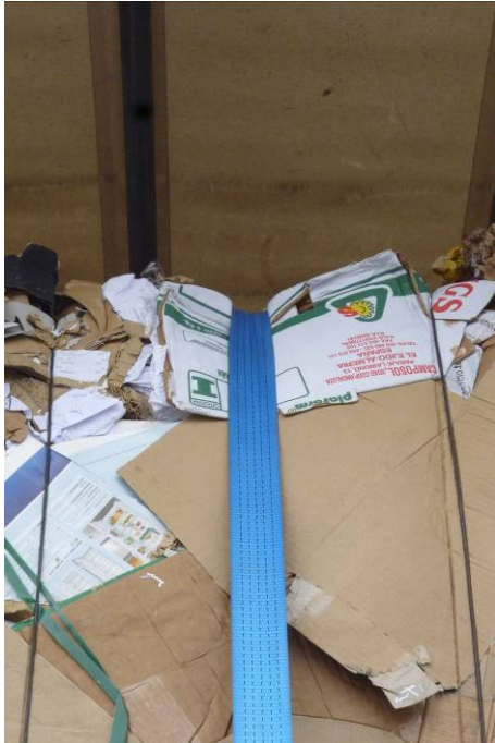
Bild 5: Einschneiden (Stabilisieren) des Zurrgurtes ins Altpapier
